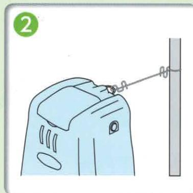
本体後ろ上部にUボルトが取付けてあります。針金・ヒモなどで倒れないように雨といの受金具などに固定してください。
