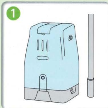
本体の置き場所と取り付ける雨といを決めます。その際、必ずタンクが水平になるように置いてください。
