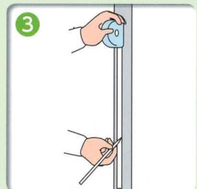
雨といの切断する上下の位置にビニールテープ(又はマジック)で印を付けます。
