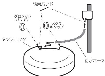
【雨水タンクを雨トイの右側に設置する場合】
