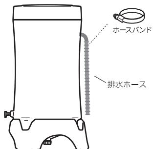
\*かんたんな集水量の計算方法:屋根面積1m<sup>2</sup>に1時間あたり1mmの降雨があった場合、1時間あたり1l貯める事ができます。たとえば集水面積が10m<sup>2</sup>、降雨量が5mm/hの場合は1時間あたり50l貯める事ができます。(蒸発などは計算外)
