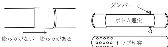
※煙突の長さはお好みで延長いただけますが、ボトム煙突とトップ煙突は必ずご使用ください。
